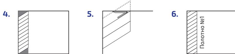
**На третьем этапе** соединяем полотно №1 и полотно №2. Для этого полотно №2 подносится к полотну №1 под углом, вставляется в замок и защелкивается (рисунок 7).
