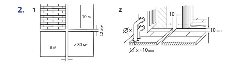
Обращаем ваше внимание, что компенсационные швы необходимо соблюдать не только по периметру комнаты. Требуется оставлять зазоры между ламинированным паркетом и трубами отопления, а также между панелями ламинированного паркета, уложенного в разных комнатах в дверных проемах (рисунок 2.2). То же самое относится к дверным коробкам.
