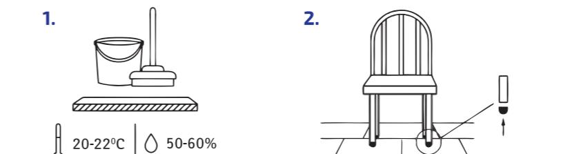
Недопустима обработка ламинированного паркета абразивными средствами. Это касается не только уборки, но и обслуживания напольного покрытия. Страйтесь избегать трения поверхности ламинированного паркета. Избежать этого можно, например, с помощью войлочных накладок, помещенных на часто перемещаемые предметы (рисунок 2).
